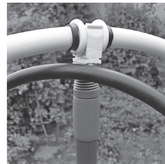
写真5 結合ループとメインループの接近部分。結合ループの位置や角度を調整できる
