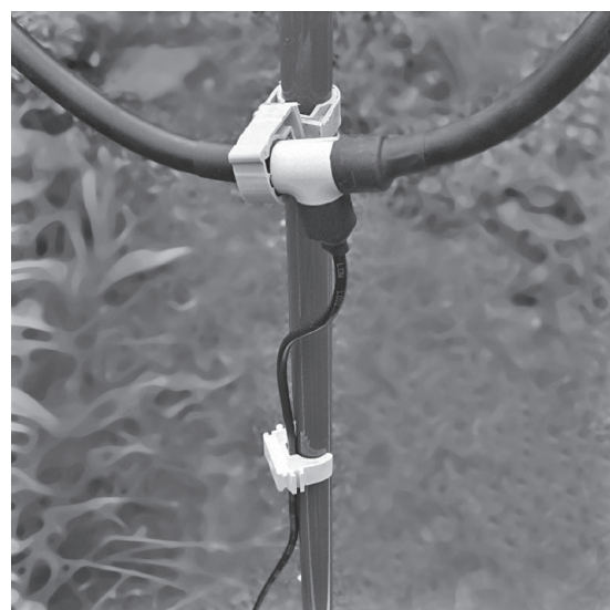
写真3 結合ループと同軸ケーブルの接合部
