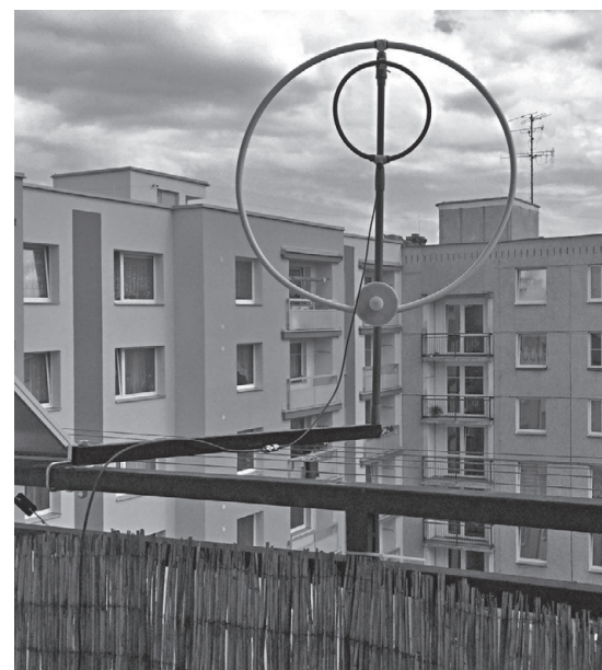
写真8 MLA-ERを集合住宅のバルコニーに設置している例
