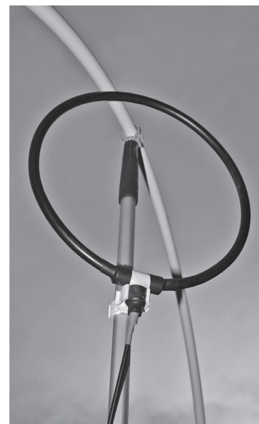
写真1 FCC(ファラデー・カップリング・コイル)を使用した給電ループで、メインループ面に対する角度を変えられる
