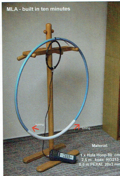
Antena realizada con un aro Hula Hoop y un trozo de tubo de polietileno/aluminio
