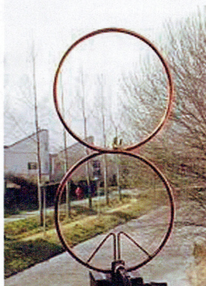
Esto es libertad de diseño: Dos antenas MLA que nos recuerdan el logo de Barreiros, una en un solo plano, la otra con los planos cruzados y ambas con diferente sistema de adaptación de impedancias
