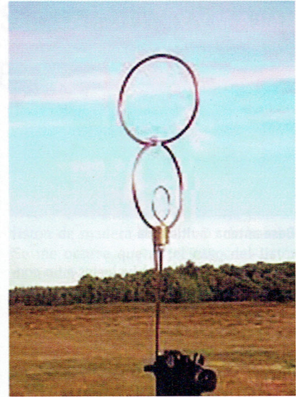
Esto es libertad de diseño: Dos antenas MLA que nos recuerdan el logo de Barreiros, una en un solo plano, la otra con los planos cruzados y ambas con diferente sistema de adaptación de impedancias
