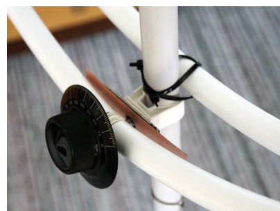
Obr. 52. Detail ladění MLA-ER III
