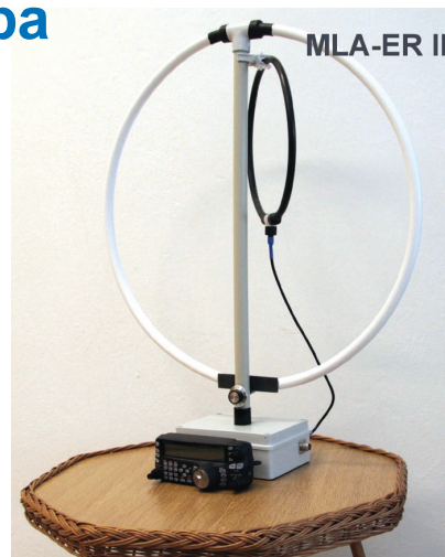
Obr. 50. Anténa MLA-ER II buzená FCC
