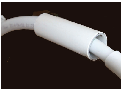
Obr. 42 a 43. Praktické provedení virtuálního kondenzátoru
