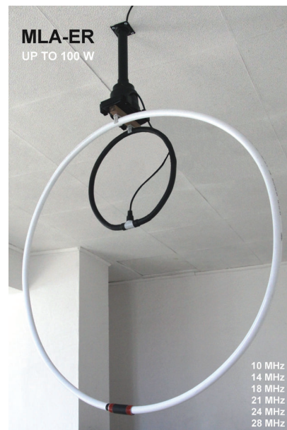
Obr. 39. MLA-ER s rotátorem, upevněným na stropě
