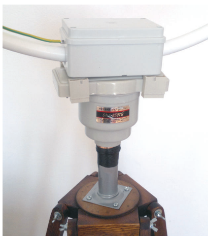
Obr. 35 a 36. Dva detailní pohledy na uchycení antény k rotátoru
