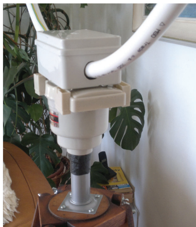
Obr. 35 a 36. Dva detailní pohledy na uchycení antény k rotátoru
