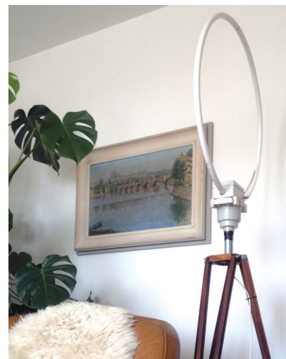
Obr. 34. Anténa MLA-ER na stojanu s rotátorem
