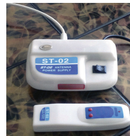
Obr. 37. Napájecí zdroj rotátoru s ovladačem otáčení antény
