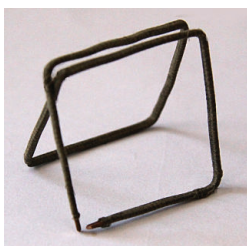
Obr. 28. Princip „smotání“ 20metrové smyčky MLA-B
