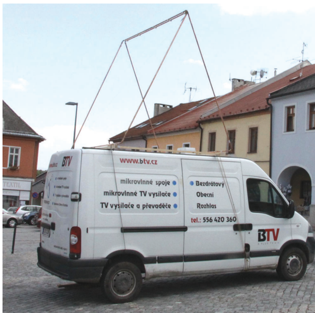
Obr. 29. MLA-B provozovaná na střeše automobilu
