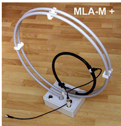
Obr. 19. Anténa MLA-M+ s Faradayovou budící smyčkou
