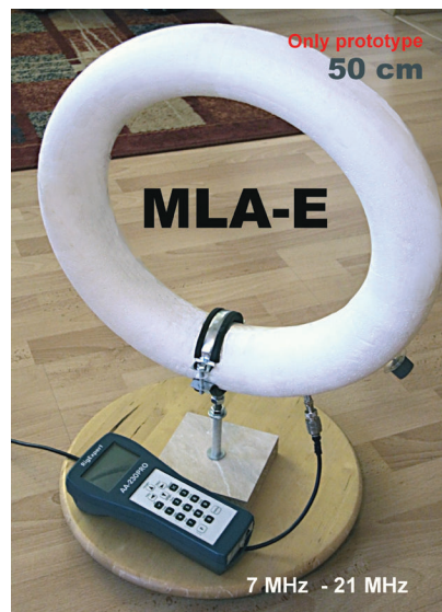
Obr. 5. MLA-E s anténním analyzátelem
