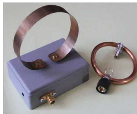
Obr. 8. Dvě varianty prototypů „trojrozměrné“ MLA-VHF, UHF. Anténa vpravo je dárek od JR10AO (návštěva v Klímkovicích, 2019)
