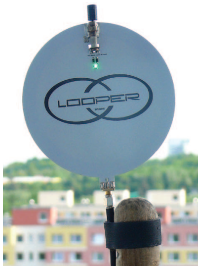
Obr. 2. Anténa MLA-VHF instalovaná na balkóně v 11. poschodí (JO70DB). Všimněte si indikace rezonance LED
